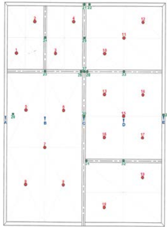
Figure 1. Diagram of a partition and arrangement of measuring thermocouples Rycina 1. Schemat przegrody i plan rozmieszczenia termoelementów pomiarowych
