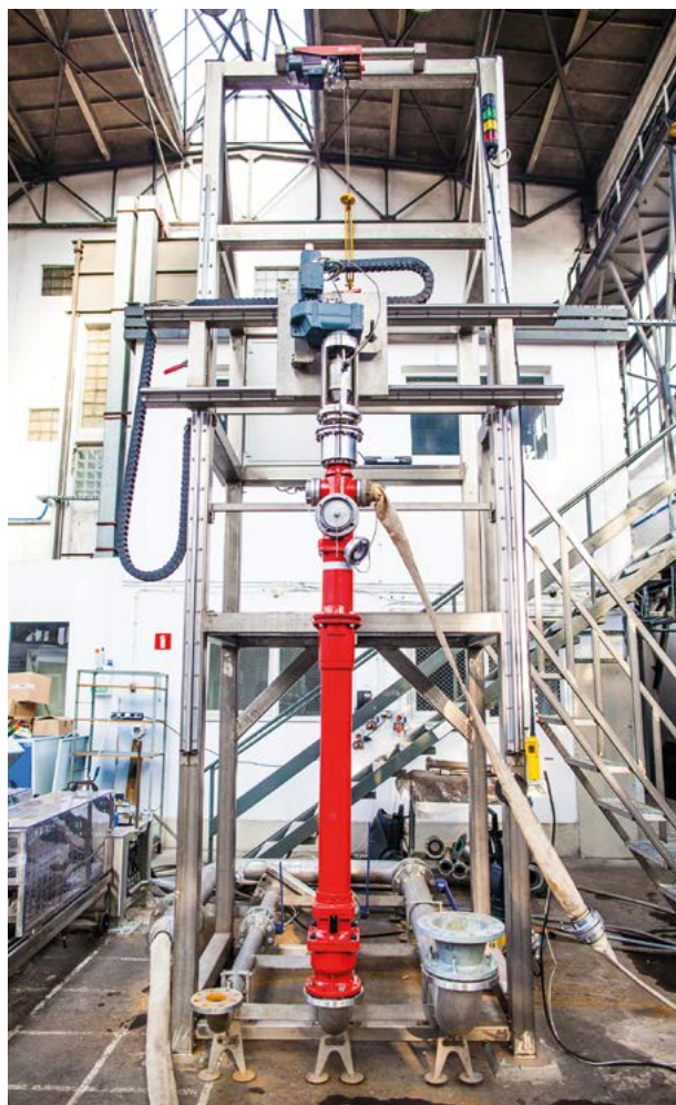
Rycina 26. Stanowisko do badania hydrantów nadziemnych Źródło: Archiwum CNBOP-PIB.
