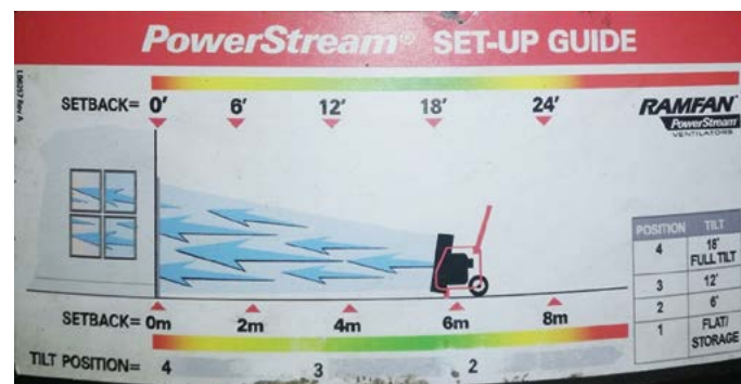
Figure 10. Graphic showing recommendations for positioning a mobile fan in front of the inlet opening Rycina 10. Grafika prezentująca rekomendacje pozycjonowania mobilnego wentylatora przed otworem wlotowym Source: Own elaboration. Źródło: Opracowanie własne.
