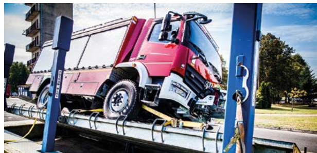
Rycina 20. Stanowisko do badania granicznego kąta przechyłu pojazdów Źródło: Archiwum CNBOP-PIB.
