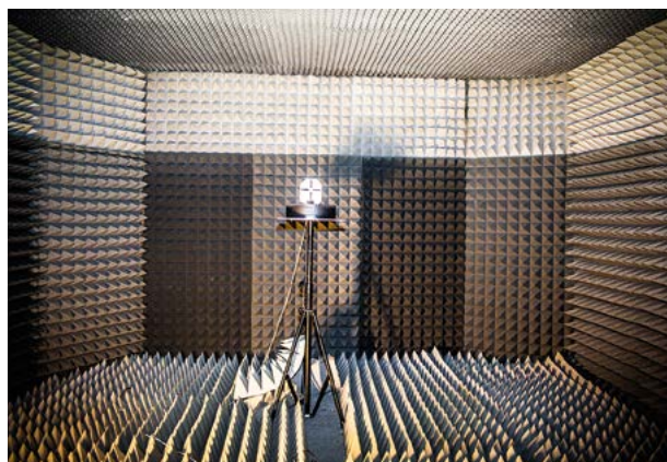
Rycina 6. Stanowisko do badań parametrów akustycznych głośników Źródło: Archiwum CNBOP-PIB.
