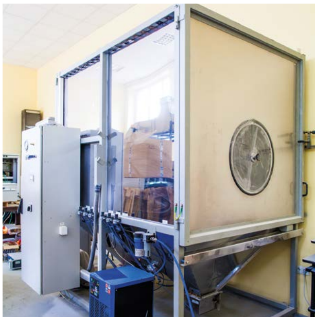
Rycina 4. Stanowisko do badania zabezpieczeń przed wnikaniem pyłu do obudowy urządzeń Źródło: Archiwum CNBOP-PIB.
