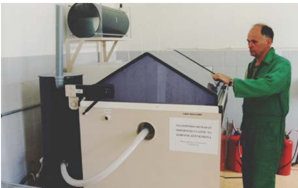
Rycina 22. Stanowisko do badania odporności gaśnic na korozję zewnętrzną
