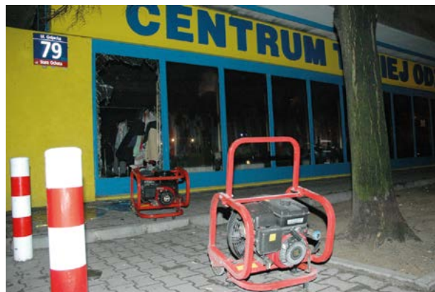
Figure 12. Use of mobile fans in a line perpendicular to the door opening (one behind the other configuration) Rycina 12. Zastosowanie mobilnych wentylatorów w linii prostopadłej do otworu drzwiowego (konfiguracja jeden za drugim)
