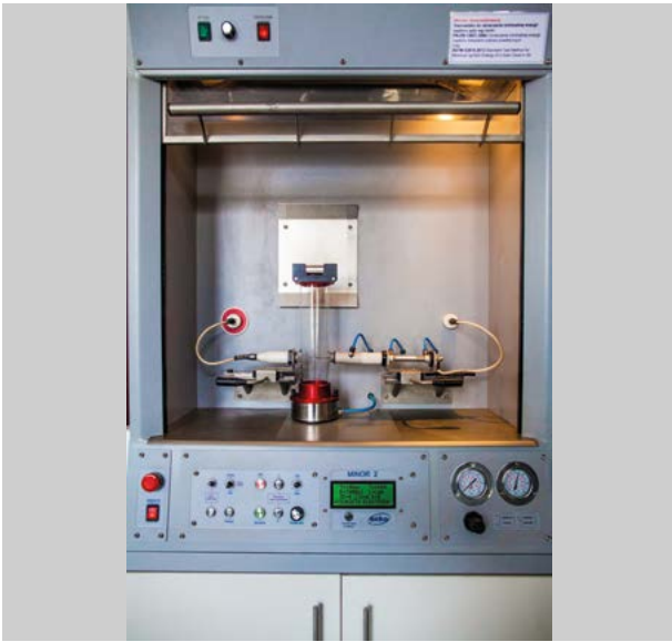
Rycina 12. Stanowisko do wyznaczania minimalnej energii zapłonu obłoku pyłu w rurze o pojemności 1,2 dm 3 , w układzie z elektrodą ruchomą.
