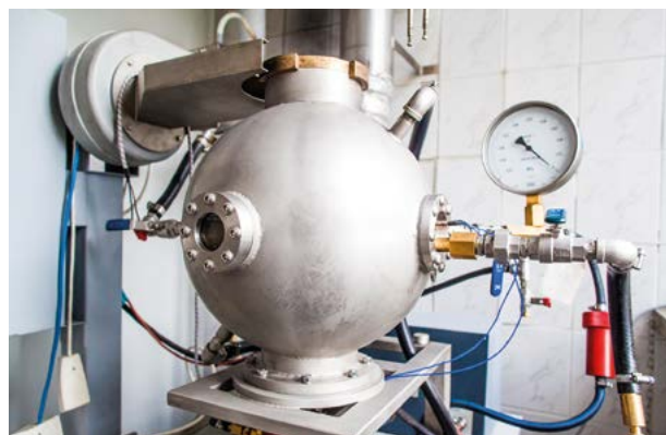
Rycina 10. Stanowisko do wyznaczania parametrów charakteryzujących wybuch pyłowo-powietrzny wg normy PN-EN 14034 przy użyciu 20 dm 3 sfery Źródło: Archiwum CNBOP-PIB.
