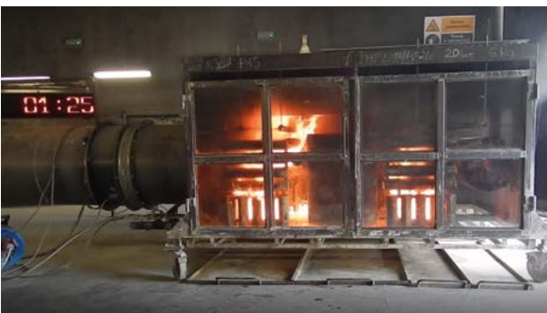
Rycina 15. Badanie systemów gaszenia komór silnikowych pojazdów wg Regulaminu 107 UN/ECE 1201812371, Zał.13
