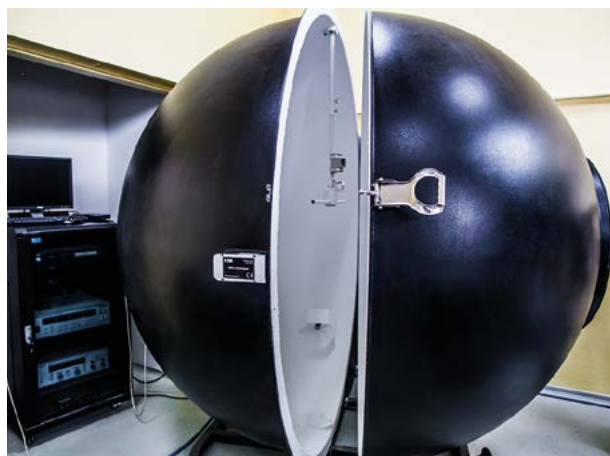
Rycina 5. Stanowisko do badań strumienia świetlnego Źródło: Archiwum CNBOP-PIB.
