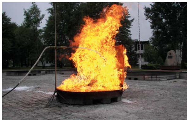
Rycina 25. Stanowisko do badania skuteczności gaśniczej w dużej skali środków pianotwórczych do wytwarzania piany ciężkiej służącej do powierzchniowego gaszenia cieczy palnych
