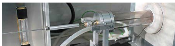
Rycina 11. Badanie gazów wydzielających się podczas spalania materiałów pochodzących z kabli i przewodów. Oznaczenie zawartości halogenowodorów wg PN-EN 60754-1:2014-11 Źródło: Archiwum CNBOP-PIB.
