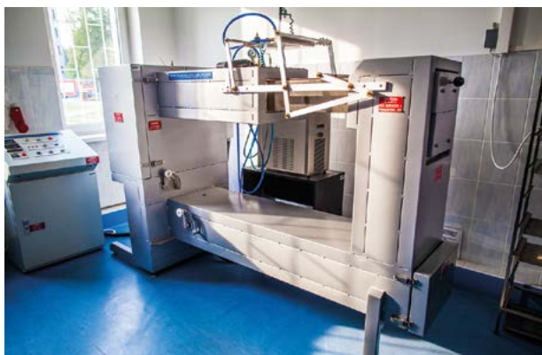
Rycina 23. Stanowisko próby reagowania na wzrost temperatury zewnętrznej Źródło: Archiwum CNBOP-PIB.
