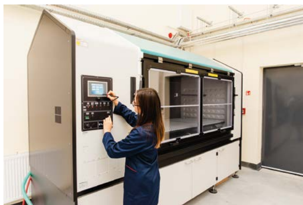
Rycina 7. Komora do wykonywania próby z SO 2 z ogólną kondensacją wilgoci Źródło: Archiwum CNBOP-PIB.
