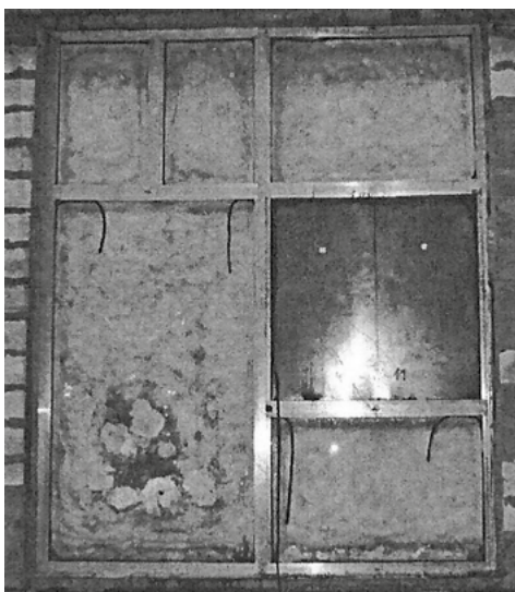
Figure 6. View of the partition from the outside after the heating test is completed Rycina 6. Widok przegrody od strony zewnętrznej po zakończonej próbie ogrzewania
