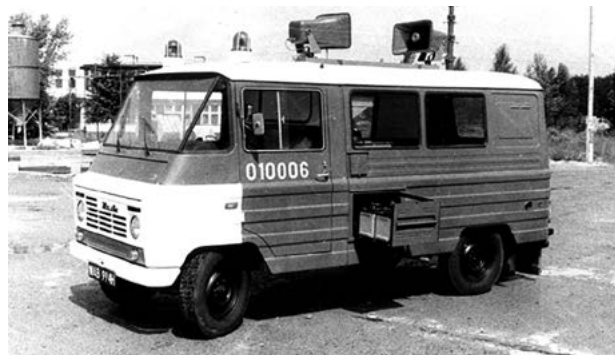
Rycina 16. Lekki samochód dowodzenia i łączności na podwoziu ŻUK Źródło: Archiwum CNBOP-PIB.
