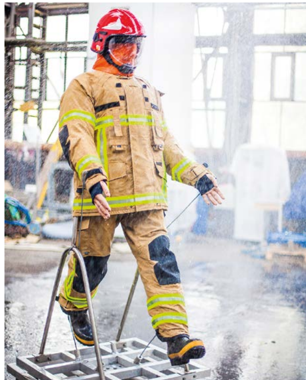
Rycina 19. Stanowisko do badania przemakalności ubrania strażackiego Źródło: Archiwum CNBOP-PIB.
