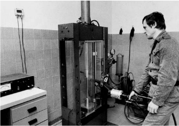
Rycina 17. Stanowisko do badania sprzętu hydrauliki siłowej Źródło: Archiwum CNBOP-PIB.
