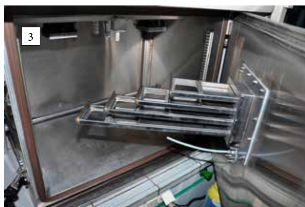
Ryc. 3. Aparatura do badań procesów likwidacji skażeń czynnikami gazowymi: 1 – odparownik (waporyzator); 2 – komora badawcza; 3 – widok systemu szuflad na próbki od strony wnętrza komory [6]
