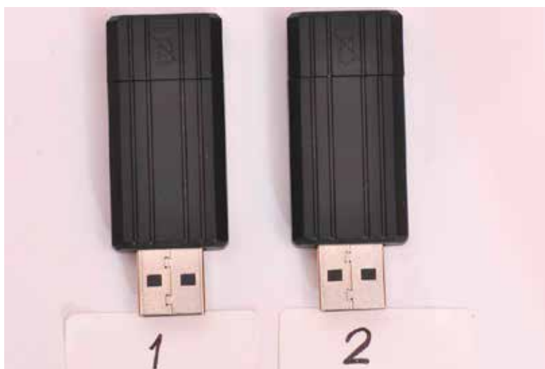
Ryc. 12. Pamięć USB Flash 4 GB poddana działaniu 2000 ppm H_2O_2 przez 4 h w temp. 50°C (1) i urządzenie kontrolne (2) Fig. 12. USB Flash Drive 4GB exposed to 2000 ppm H_2O_2 for 4 h at 50°C (1) and a control device (2)
