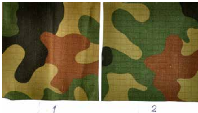
Ryc. 8. Próbkę tkaniny podgumowanej P1 poddana działaniu 2000 ppm H_2O_2 przez 6 h w temp. 50°C (1) i próbkę kontrolną (2)
