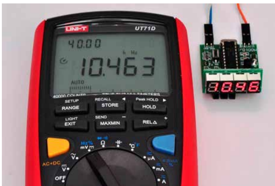
Ryc. 9. Kontrola poprawności wskazań miernika AVTMOD10 Fig. 9. Control of correctness of AVTMOD10 meter indications
