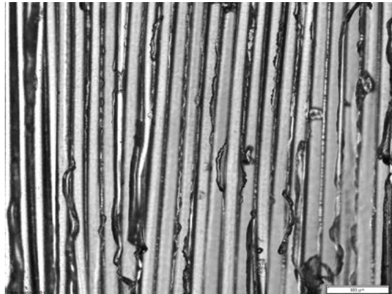
Figure 13. Photograph of the adhesive surface on the inner lining (PVC) of a reference sample, not exposed to UV light Rycina 13. Zdjęcie powierzchni kleju na wykładzinie wewnętrznej (PVC) próbki referencyjnej, nie poddanej ekspozycji na oddziaływanie promieniowania UV
