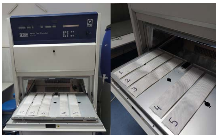
Figure 7. Fragments of hose tape placed in a chamber for UV and water exposure (consecutive) Rycina 7. Fragmenty taśmy węzowej umieszczone w komorze w celu poddania ekspozycji na promieniowanie UV oraz działania wody (następujące po sobie)
