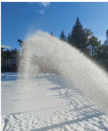
Figure 19. Foam produced from a solution of foaming extinguishing agent Rycina 19. Piana wytworzona z roztworu pianotwórczego środka gaśniczego
