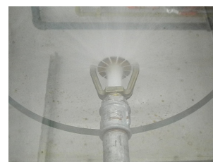
Ryc. 2. Ilość rozpraszanej wody i uśredniona procentowa ilość dla tryskacza wiszącego ESFR ASCOA model K-1 Fig. 2. The amount of dispersed water and the average percent volume attributed to a hanging ESFR ASCOA sprinkler, type K-1
