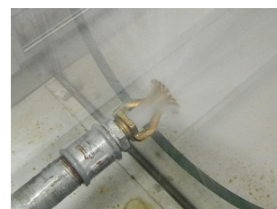
Ryc. 3. Ilość rozpraszanej wody i uśredniona procentowa ilość dla tryskacza wiszącego Viking model VK510 Fig. 3. The amount of dispersed water and the average percent volume attributed to a hanging Viking sprinkler, type VK 510
