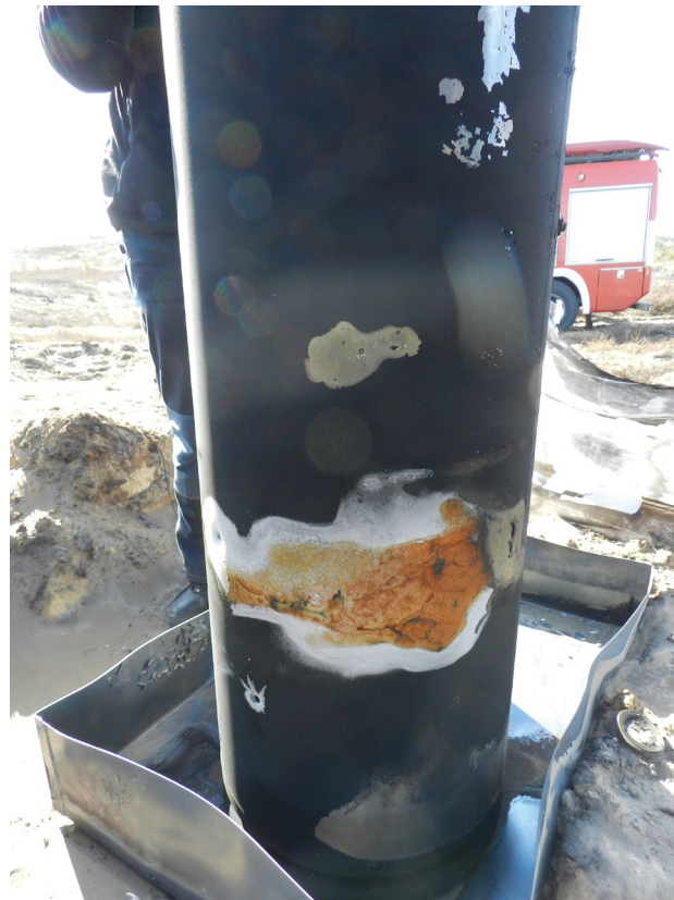
Figure 3. LNG tank after activation of the safety valve and after burning Rycina 3. Zbiornik LNG po aktywacji zaworu bezpieczeństwa i spalaniu
