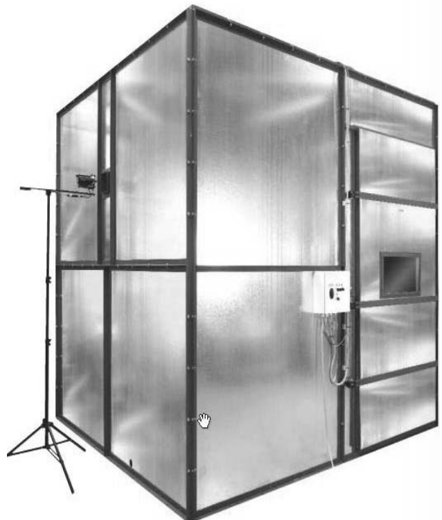
Ryc. 6 Stanowisko badawcze wg PN-EN 61034-1 [18]
