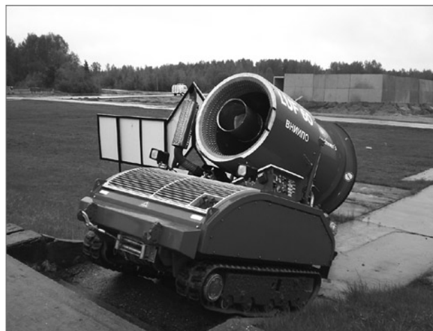
Рис.3. Мобильная установка пожаротушения LUF-60 Fig. 3. Mobile Fire Suppression System LUF-60
