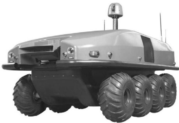
Рис.16. Мобильное роботизированное транспортное средство CHRUSOR
