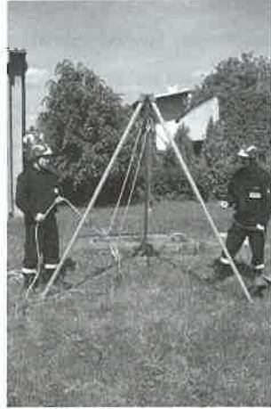
Fot. 4. Układ wyciągowy dla ratownika 1:3 ; układ wyciągowy dla uszkodzanego 1:4
