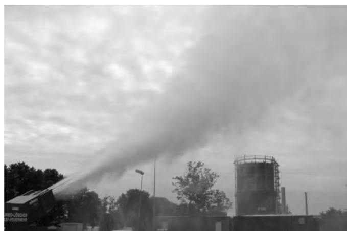
Fot. 4. Gaśniczy samochód turbinowy ZZSP BASF. Pokaz wydajności uzyskiwanego strumienia rozproszonego
