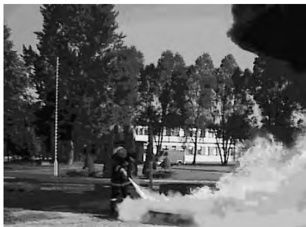
Fot. 2. Przykładowy sposób gaszenia pożaru testowego grupy B[13]
