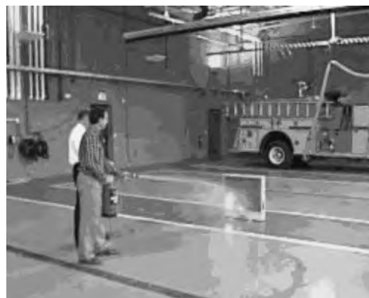
Fot. 3. Przykładowy sposób gaszenia pożaru testowego grupy C [11]
