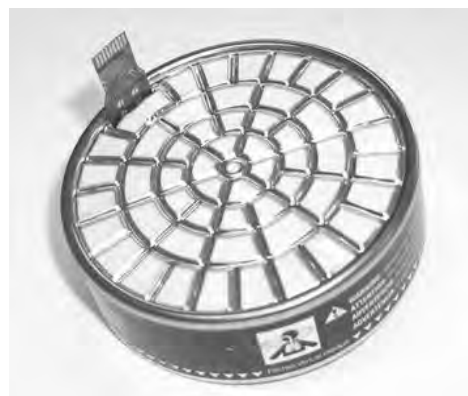
Fot. 7. Prototypowy filtropochłaniacz z detektorem żywotności
