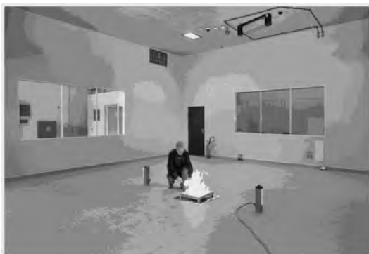
Fot. 4. Przykładowy sposób gaszenia pożaru testowego grupy D[13]
