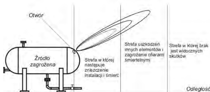
Ryc. 2. Strefy awarii i uszkodzeń dla pożaru jetfire
