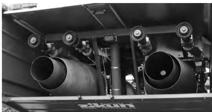
Fot. 3. Gaśniczy samochód turbinowy ZZSP BASF. Głowice rozpraszające oraz wyloty gazów spalinowych z turbin
