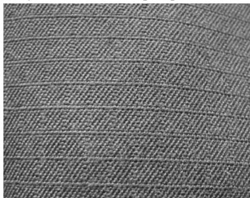
Fot. 1. Struktura tkaniny „rip stop” (źródło: zbiór fotografii Zespołu Laboratoriów BS CNBOP)
