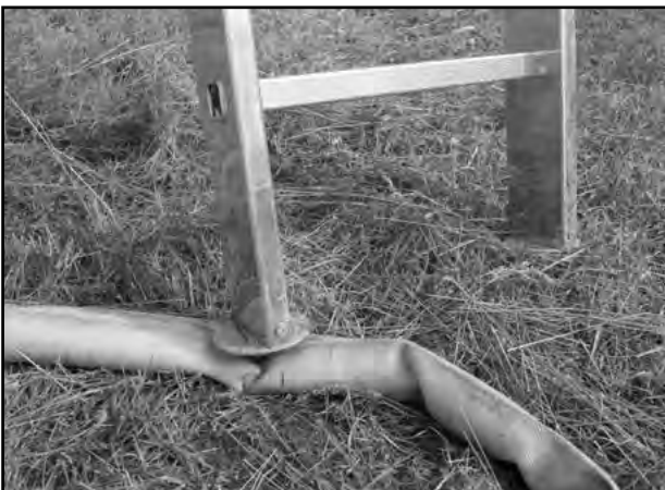
Fot. 7. Stopa drabiny ustawiona na linii węzowej
