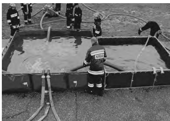
Fot. 2. Układ zbiorników z nalewakami Autor: Bernard Król
