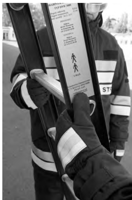
Fot. 24 i 25 Prawidłowe ułożenie dłoni podczas asekuracji
