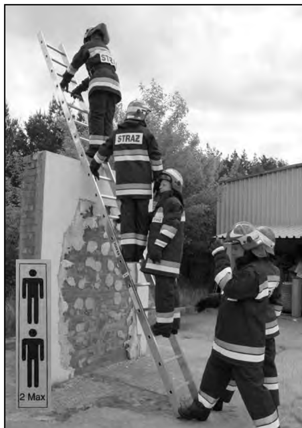
Fot. 16 Nieprawidłowe obciążenie drabiny dwuosobowej
