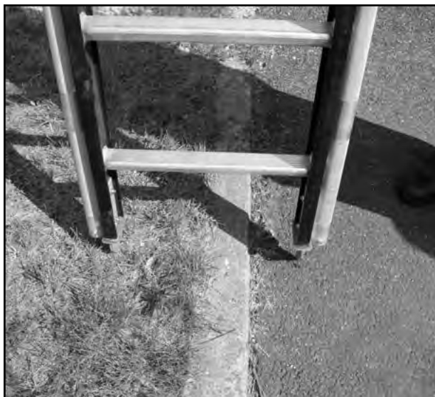
Fot. 2. Nieprawidłowe ustawienie drabiny
