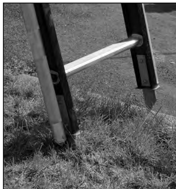
Fot. 3. i 4. Stopa lewej bocznicy zagłębiona w miękkim podłożu
