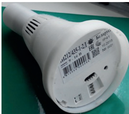
Рисунок 2. Общий вид опытного образца комбинированного пожарного извещателя
