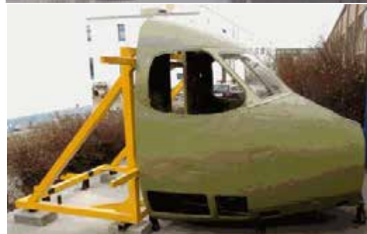
Ryc. 24. Statyw rekonfigurowany do badania elementów usterzenia i kabiny pilotów
