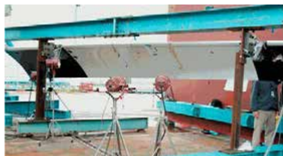
Ryc. 23. Statyw do badań elementów usterzenia [33]
