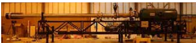
Ryc. 2. Działo pneumatyczne kalibru 250 mm z pojedynczym akumulatorem powietrza [14]
