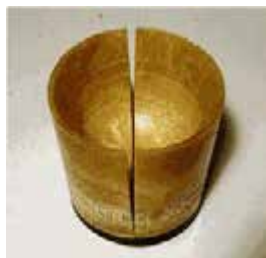
Ryc. 17. Sabot z pianki poliuretanowej [28]
