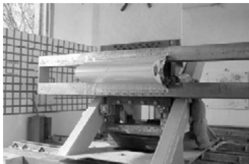
Ryc. 21. Statyw z wieloosiowym układem pomiaru siły uderzenia w krawędź natarcia [31]: a) model, b) egzemplifikacja stanowiskowa
