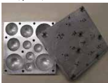
Ryc. 16. Forma do wytwarzania lodowych pocisków [28]
