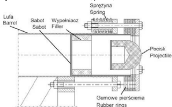
Ryc. 13. Łapacz sabota z amortyzacją gumowo-sprężynową [25]
