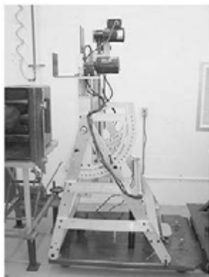
Ryc. 25. Statyw uniwersalny z regulacją pozycji kątowej [35] Fig. 25. Universal frame with variable angular position [35]
