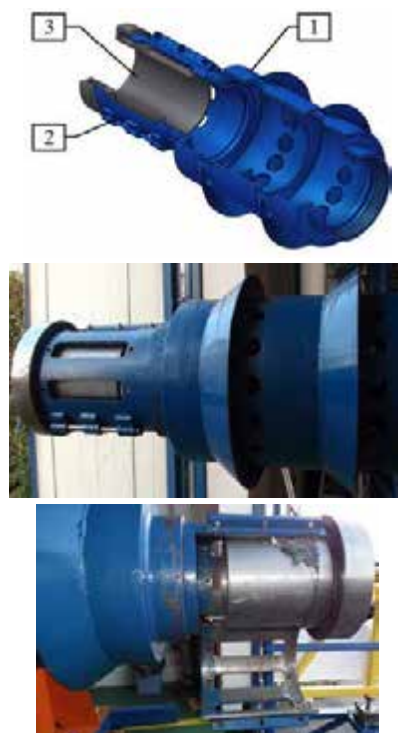
Ryc. 14. Hybrydowe urządzenie wylotowe [26]: 1 – hamulec akcyjno-reakcyjny, 2 – łapacz sabota, 3 – tuleja blokująca
