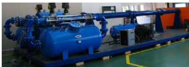
Ryc. 3. Działo pneumatyczne kalibru 250 mm z podwójnym akumulatorem powietrza [15]
