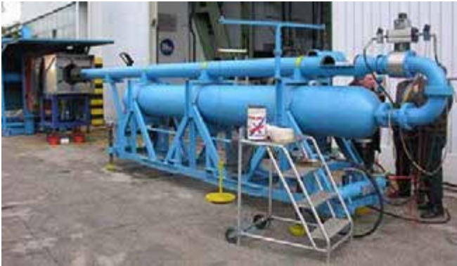
Ryc. 6. Działo pneumatyczne krótkolufowe [18] Fig. 6. Short-barrel pneumatic gun [18]
