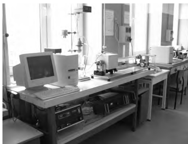
Fot. 1. Stanowisko do prowadzenia procesu rozkładu i spalania materiałów znajdujące się w pracowni Zakładu Spalania i Teorii Pożarów SGSP
