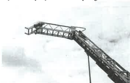
Drabina z „łamanym” przęsłem
