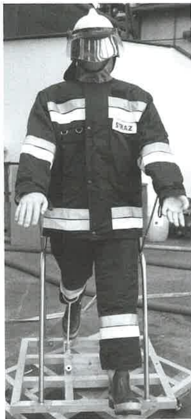
fot. 4 Stanowisko do badania odporności ubrania na przemakanie
