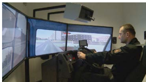
Ryc. 3. Elementy symulatora kierowcy wozu bojowego PSP [7],[11]
