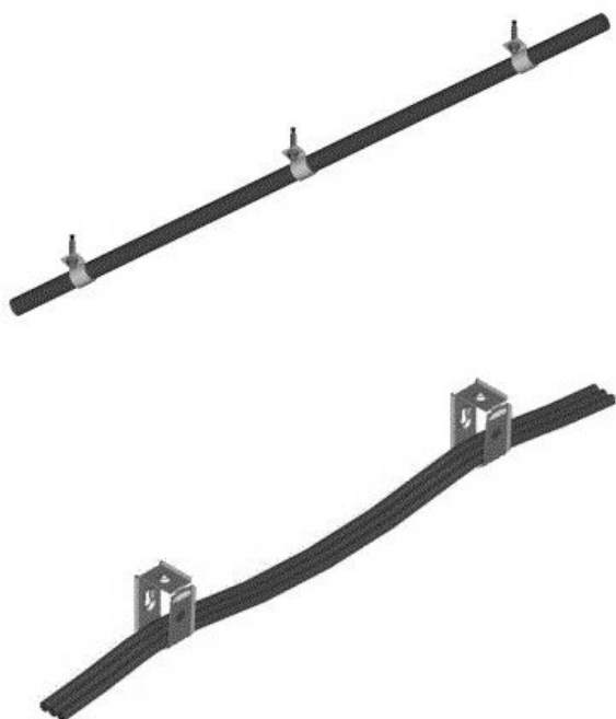
Ryc. 3. Przykłady zamocowań na uchwytych i obejmach kablowych [13]
