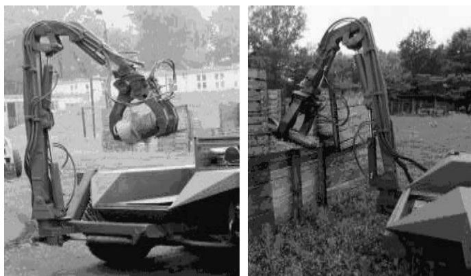
Ryc. 8. Podnoszenie ładunków: po lewej – załadunek na pojazd; po prawej – podejmowanie ładunku zza przeszkody
