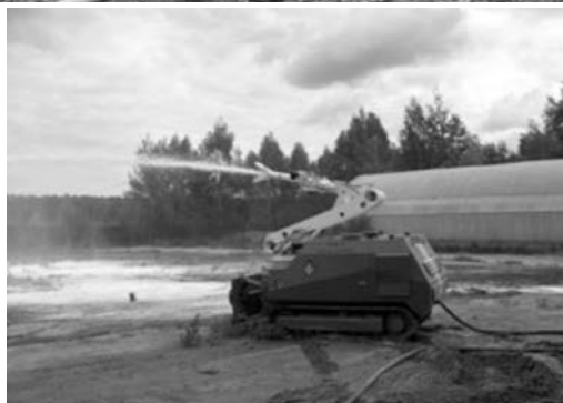
Ryc. 1. Zdalnie sterowane roboty pożarnicze minimalizujące bezpośrednie zagrożenie człowieka
