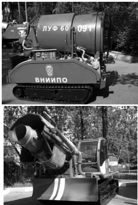
Ryc. 3. Roboty wyposażone w system do zraszania dużych powierzchni [8]
