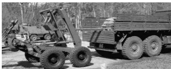
Ryc. 7. Podejmowanie ładunku z platformy pojazdu za pomocą widłowego systemu samozaładowczego
