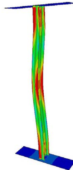
Ryc. 3. Mapy wartości naprężeń zastępczych wg hipotezy Hubera-Misesa w słupie po wyboczeniu [12]
