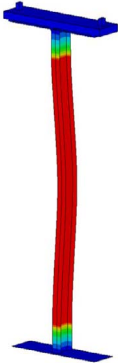
Ryc. 12. Nierównomierny rozkład pola temperatury na długości analizowanego elementu Fig. 12. Longitudinal variation of temperature along the column's length Źródło: Opracowanie własne. Source: Own elaboration.
