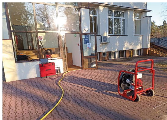
Figure 3. Method of positioning the unit in front of the construction object during the test of the flow characteristics Rycina 3. Sposób ustawienia jednostki przed obiektem budowlanym podczas badania charakterystyki przepływu
