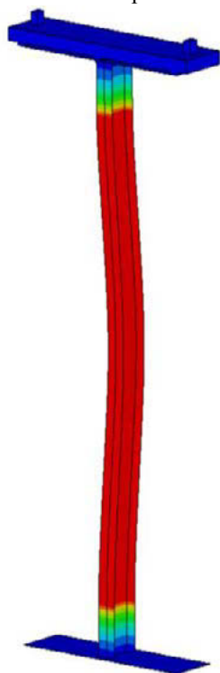
Ryc. 12. Nierównomierny rozkład pola temperatury na długości analizowanego elementu
