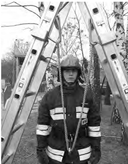
Fot. 3. Sposób przeplecenia linki przez zatrzaśniki i wpięcie ratownika schodzącego do otworu studni
