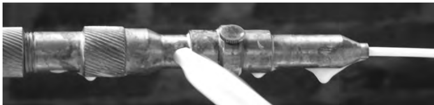
Fot. 2 Widok fragmentu prądownicy podczas przepływu piany
