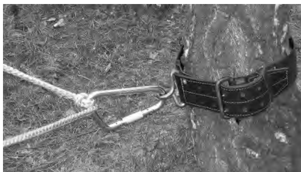
Fot. 4. Węzeł mocujący w stałym punkcie asekuracji
