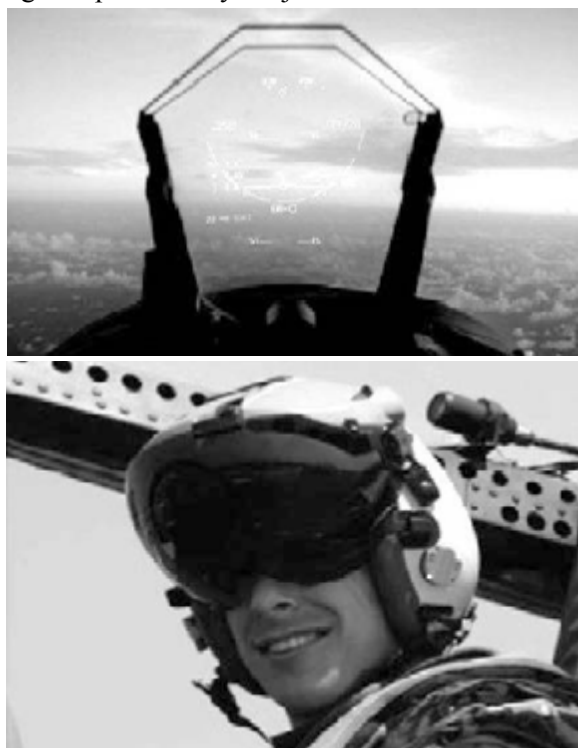
Ryc. 1. Przykładowe rozwiązania wyświetlaczy informacyjnych typu HUD (po lewej) i HMD, stosowanych w samolotach F-16 i F-18 [2,3]
