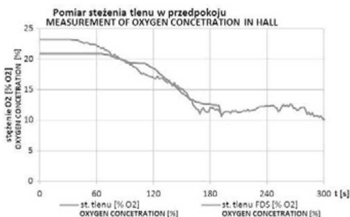
Ryc. 12. Wykres przedstawiający obliczeniowy i rzeczywisty rozkład stężenia tlenu w pomieszczeniu przedpokoju w okresie 5 min
