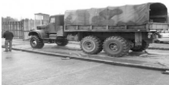
Ryc. 1. Składana kufę z PCV do mycia i/lub dekontaminacji pojazdów kołowych [16]
