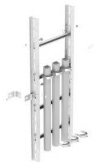
Ryc. 4. Przykłady zamocowań pionowych na drabince kablowej i uchwytych [13] Fig. 4. Examples of vertical cable bearing with ladder and holders [13]
