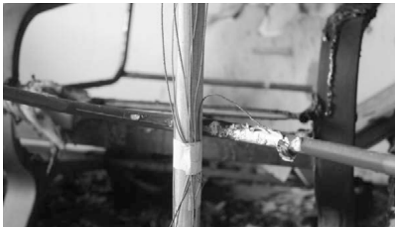
Ryc. 5. Przykład umieszczenia drzewa termopar. Wzdłuż okna PVC na zewnątrz oraz przy spalonym fotelu po wykonanym teście pożarowym
