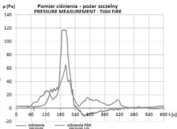
Ryc. 13. Wykres przedstawiający obliczeniowy i rzeczywisty rozkład ciśnienia w mieszkaniu doszczelnionym w okresie 10 min
