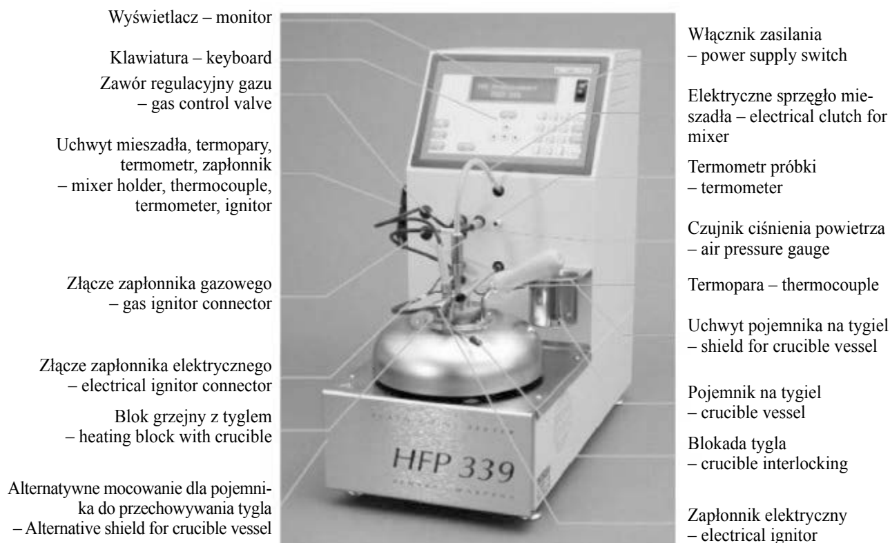
Ryc. 1. Stanowisko badawcze HFP 339 firmy Walter Herzog GmbH wraz z poszczególnymi elementami składowymi
