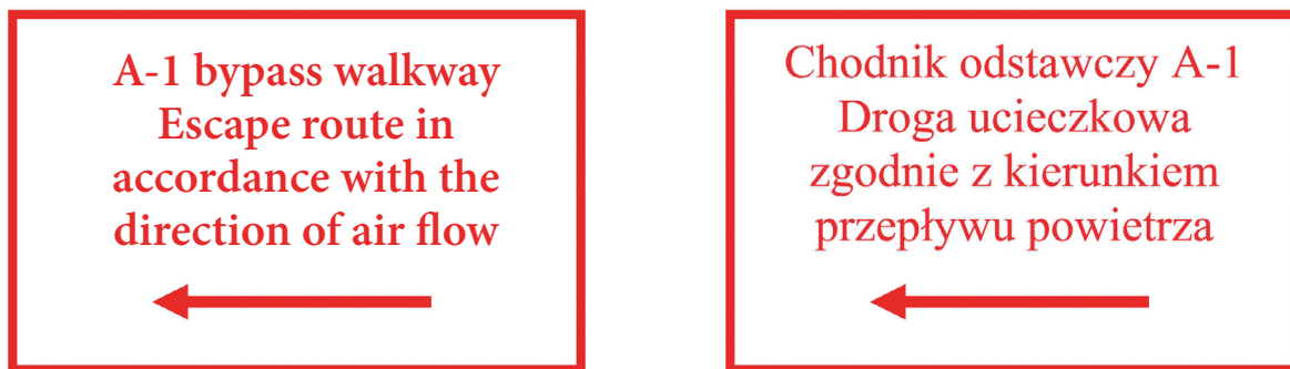
Figure 3. An example of escape route signage in a mine Rycina 3. Przykład oznakowania drogi ucieczkowej w kopalni Source: Own elaboration. Źródło: Opracowanie własne.
