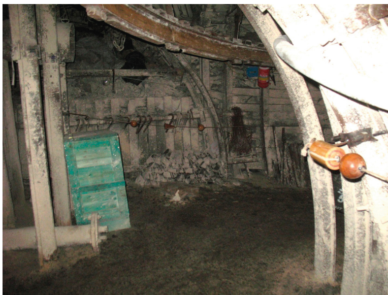
Figure 11. A system of indicators requiring the crossing of two excavations Rycina 11. Układ wskaźników nakazujący przejście przez skrzyżowanie dwóch wyrobisk Source: Own elaboration based on [13]. Źródło: Opracowanie własne na podstawie [13].
