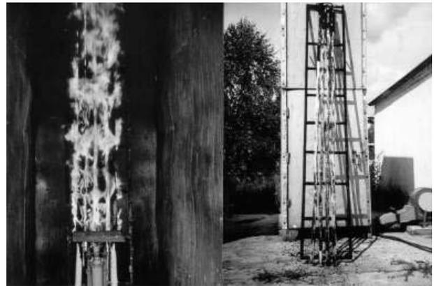
**Рис. 7.** Испытания кабельной продукции и электротехнических изделий
