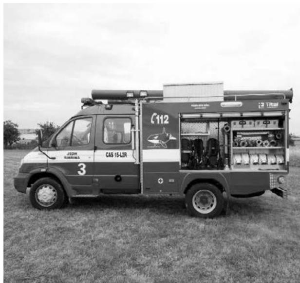
**Рис. 4.** Пожарный автомобиль первой помощи
