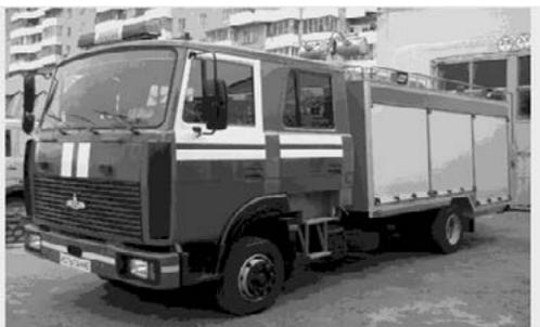
**Рис. 1.** Автомобиль быстрого реагирования АБР-0,4/130 на шасси МАЗ 437041
