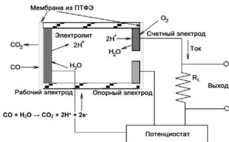
Рис. 2. Принцип действия датчика NAP-508 [10]
