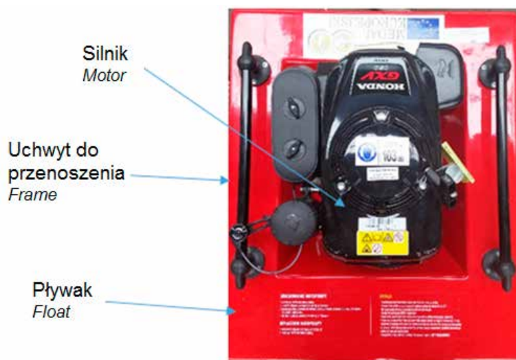
Ryc. 6. Przykładowy widok motopompy pływającej
