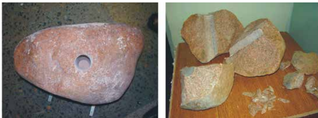
Рис. 6. Радиально-симметричное разрушение объекта из гранита при одноканальном воздействии
