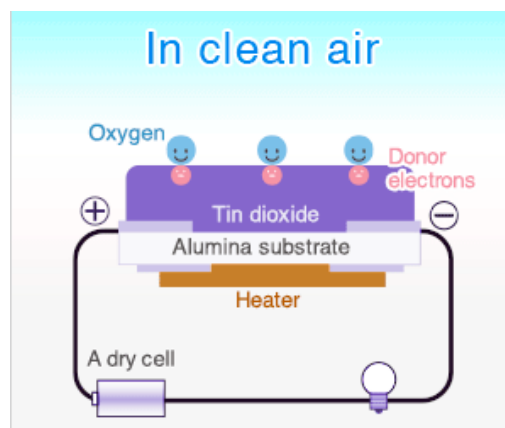
Рис. 9. Популярная демонстрация принципа работы металл-оксидного датчика [11]
