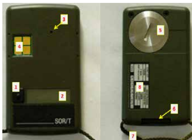
Ryc. 1. Dawkomierz indywidualny SOR/T – widok z przodu (z lewej) i z tyłu
