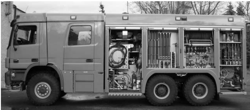
Fot. 9. Samochód pożarniczy z dzieloną kabiną (układ miejsc: 1+1+2+4)
