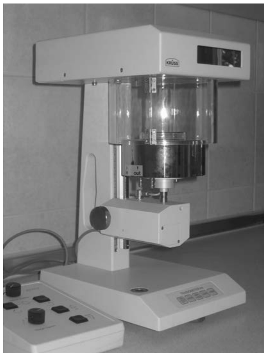
Fot.1 Widok ogólny stanowiska do oznaczania napięcia powierzchniowego ( \gamma_s ) na granicy faz ciecz-gaz oraz napięcia powierzchniowego na granicy dwóch nie miesających się cieczy tzw. napięcia międzyfazowego ( \gamma_i )
