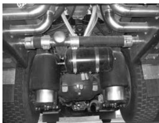
Fot. 7. Pneumatyczne zawieszenie osi tylnej samochodu ratowniczo-gaśniczego
