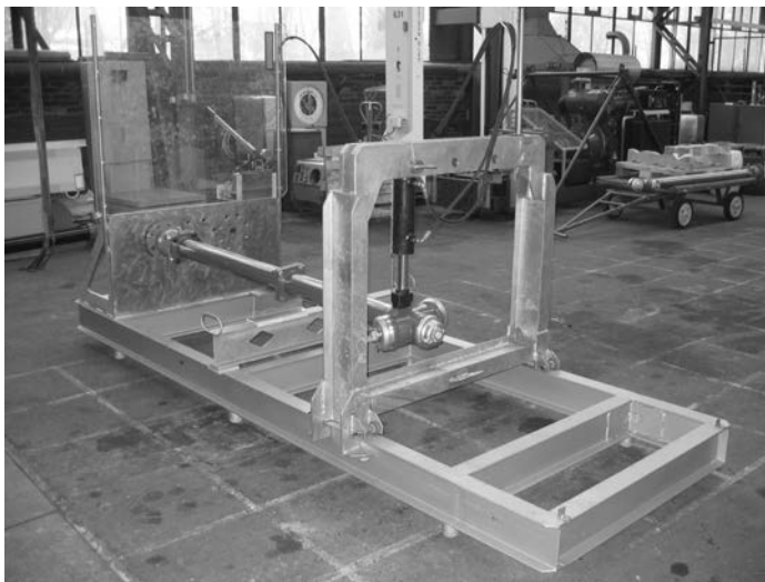
Fot. 9. Widok ogólny stanowiska do badania odporności hydrantów zewnętrznych na zginanie
