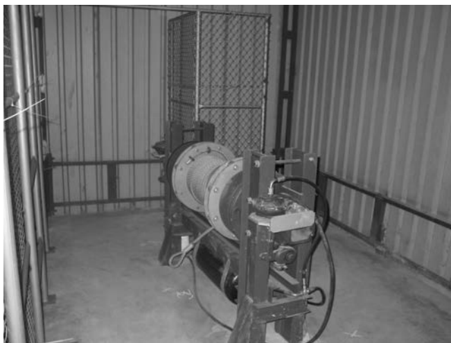
Fot. 4. Widok ogólny stanowiska do pomiaru siły uciagu wciągarek samochodowych
