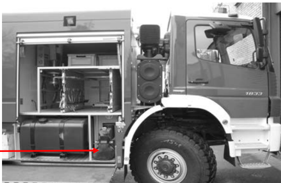
Fot. 8. Dodatkowy zbiornik AdBlue (silnik Mercedes z systemem SCR)
