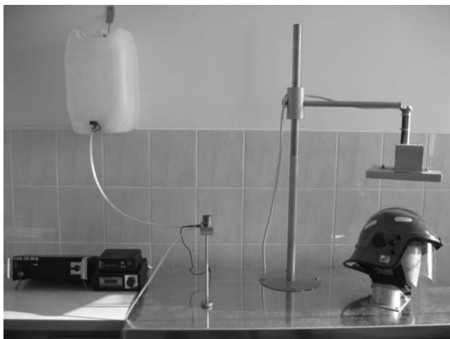
Fot. 5. Widok ogólny stanowiska do badania odporności hełmów strażackich na promieniowanie cieplne
