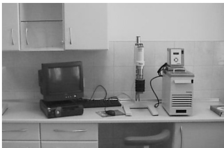
Fot.2 Stanowisko do pomiaru lepkości dynamicznej wiskozymetrem rotacyjnym z układem termostatu i jednostką sterującą
