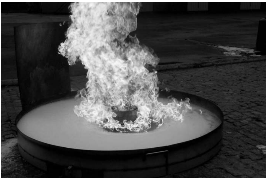
Fot. 3 Badanie nawrotu palenia wg PN-EN 1568 cz.3
