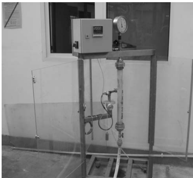
Fot. 7. Widok ogólny stanowiska do badania odporności pożarniczych węży tłocznych na kontakt z gorącą powierzchnią
