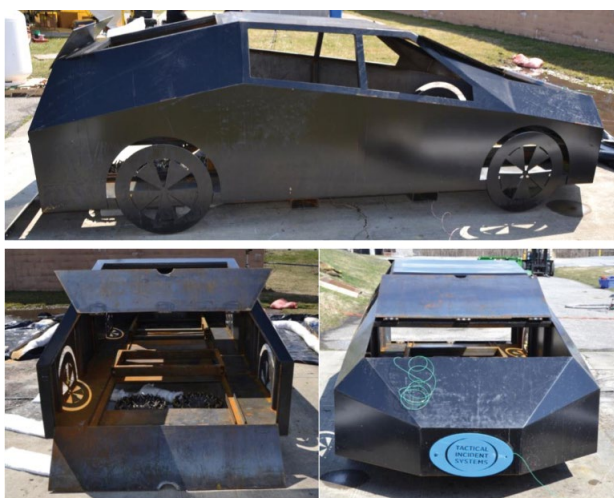
Figure 15. View of the stand imitating a vehicle for testing Rycina 15. Widok stanowiska imitujące pojazd do testów
