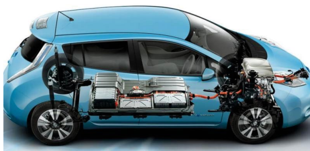
Figure 1. A set of batteries located in a part of the vehicle floor Rycina 1. Zespół akumulatorów umieszczonych w podłodze pojazdu
