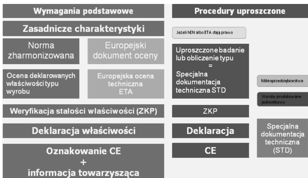
Ryc. 2. Drogi do wprowadzenia wyrobów budowlanych do obrotu [Źródło: opracowanie własne na podstawie Rozporządzenia CPR]
