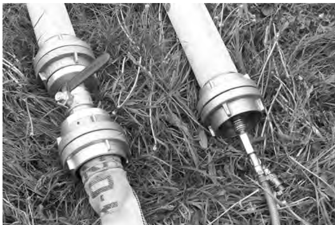
Fot. 2. Napełnienie węża wodą i powietrzem
