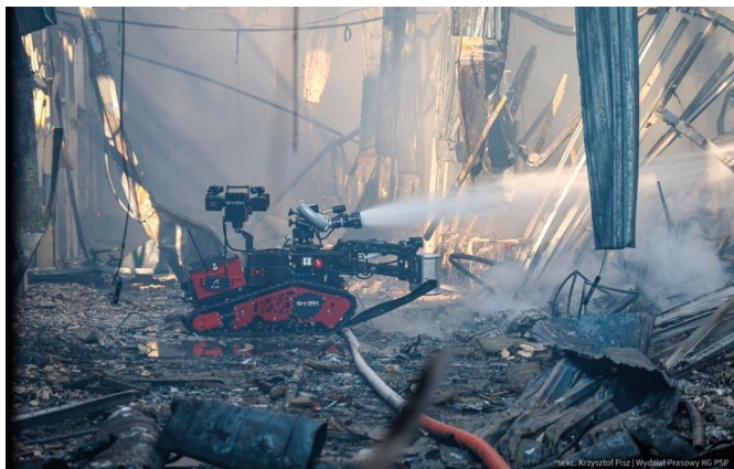
Figure 7. Robot Colossus in operation during the fire of the Marywilska Rycina 7. Robot Colossus w trakcie działań przy pożarze hali Marywilska
