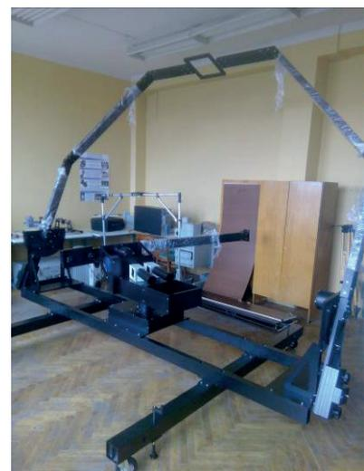
Рисунок 6. Внешний вид гониометрической установки «Визир» (с различными углами кран-штатива)
