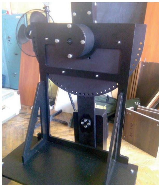
**Рисунок 8.** Узел вертикального крепления кран – штатива с дискретной шкалой
