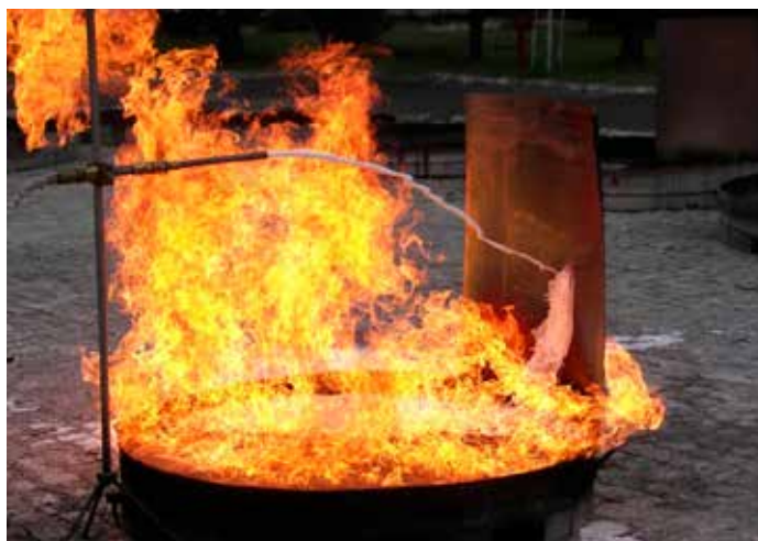
Ryc. 2. Badanie skuteczności gaśniczej pianotwórczych środków gaśniczych (podawanie łagodne) wg [15]
