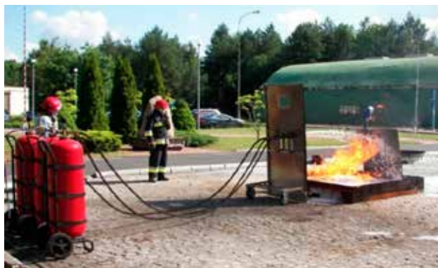
Ryc. 5. Badanie skuteczności gaśniczej wg [19] z zastosowaniem 3 prądownic Fig. 5. Extinguishing effectiveness test according to [19] delivery with 3 nozzles
