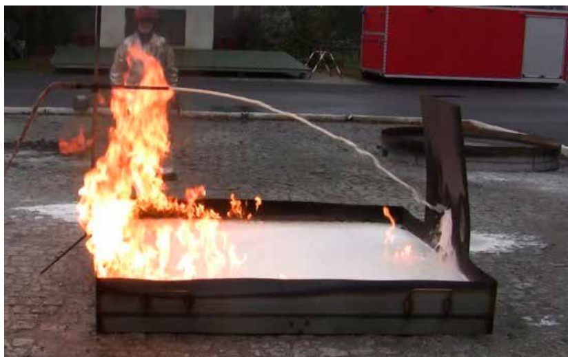
Ryc. 4. Badanie skuteczności gaśniczej wg [19] Fig. 4. Extinguishing effectiveness test according to [19]
