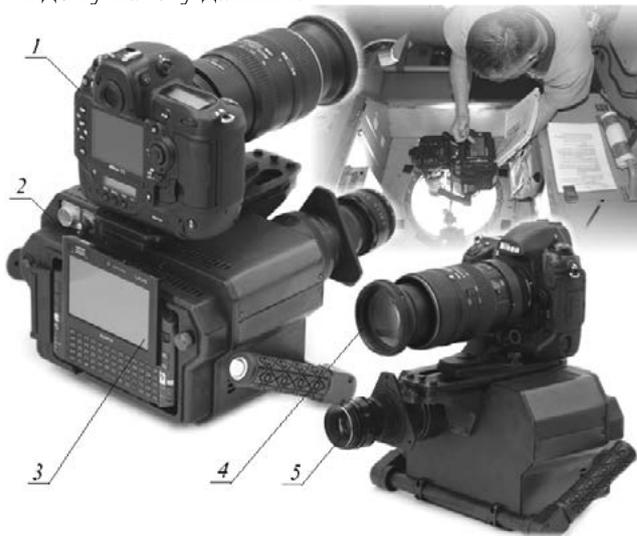
**Рис. 2.** Внешний вид фотоспектральной системы, съемка с борта МКС космонавтом Ф. Юрчихиным:
