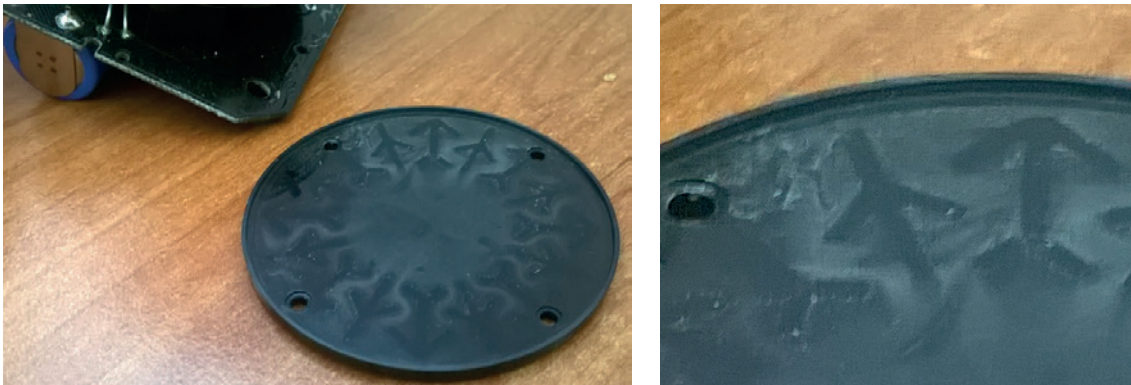
Rycina 4. Pokrywa komory czujki dymu ze śladami kurzu
