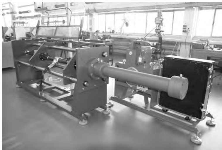
Fot. 1. Stanowisko do badania hydraulicznych narzędzi ratowniczych
