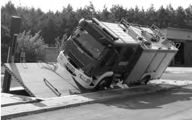
Fot. 1. Stanowisko do pomiaru granicznego kąta przechyłu bocznego pojazdów pożarniczych
