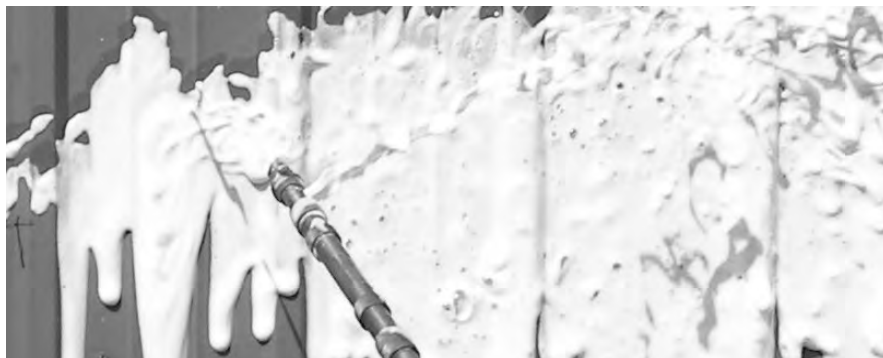
Ryc. 8. Piana wytworzona ze środka M13 o temperaturze 20°C zbudowana jest z bardzo drobnych baniek
