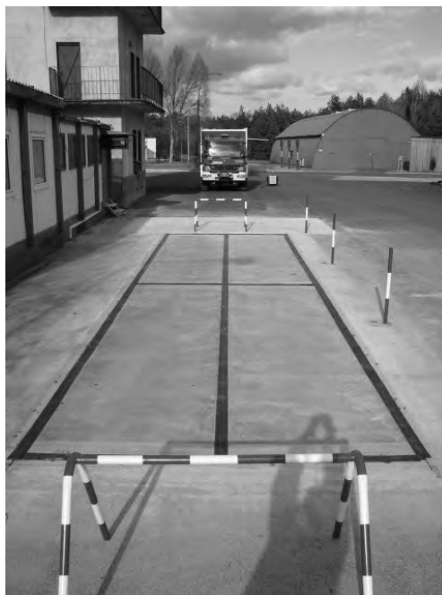
Fot. 3. Stanowisko do pomiaru mas i nacisków na osie i strony pojazdów pożarniczych
