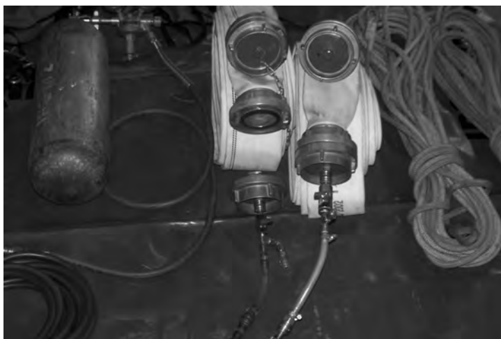
Fot. 2. Podłączenie węży tłocznych do butli powietrznej
