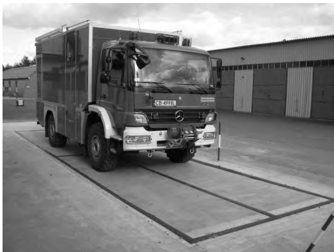
Fot. 4. Stanowisko do pomiaru mas i nacisków na osie i strony pojazdów pożarniczych
