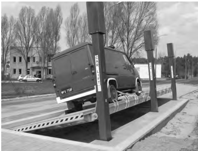
Fot. 2. Stanowisko do pomiaru granicznego kąta przechyłu bocznego pojazdów pożarniczych
