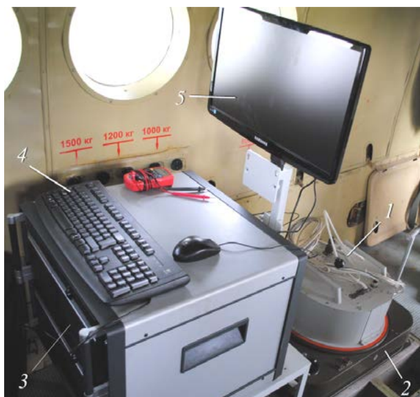
Рис. 9. Система АВИС, установленная на борту самолета АН-2: 1 – блок оптических датчиков; 2 – гиropлатформа PAV-20;
