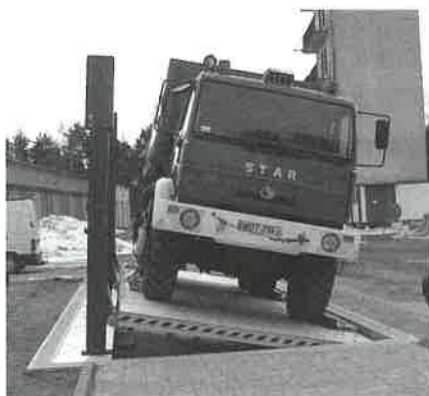
Widok stanowiska do pomiaru granicznego kąta przechyłu bocznego samochodów
