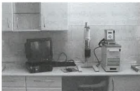
Stanowisko do pomiaru lepkości dynamicznej wiskozymetrem rotacyjnym z układem termostatującym i jednostką sterującą
