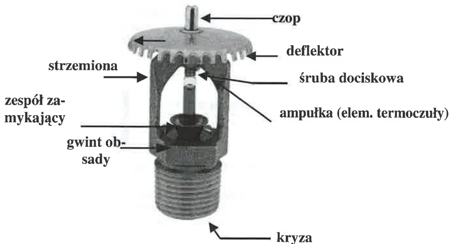
ZDJĘCIE 1. Budowa tryskacza
