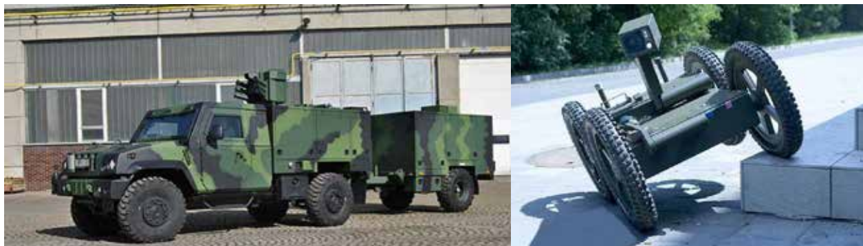
Rycina 13. Samochód do rozpoznania skażeń S-LOV-CBRN z samobieżnym robotem [46]
