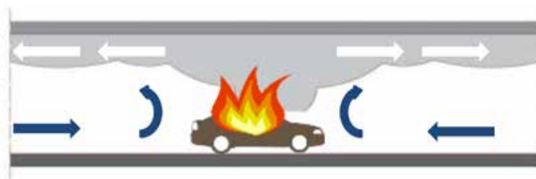
Rycina 1. Przemieszczanie się warstwy dymu przy prędkościach 0–1 m/s [1]
