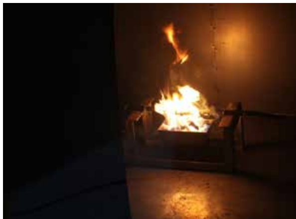
Rycina 6. Przykładowe badanie wg PN-EN 61034-2 w CNBOP-PIB
