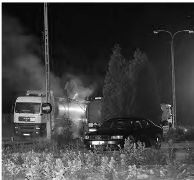
Ryc. 3. Ratownicy pracujący na rozszczelnionej cysternie – obok cysterna zastępcza, do której przepompowano kwas
