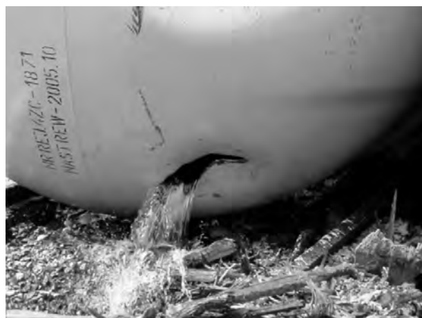
Fot. 3. Miejsce rozszczelnienia cysterny z 1-oktanołem [1] Photo 3. Place of discharge of 1-octanol [1]
