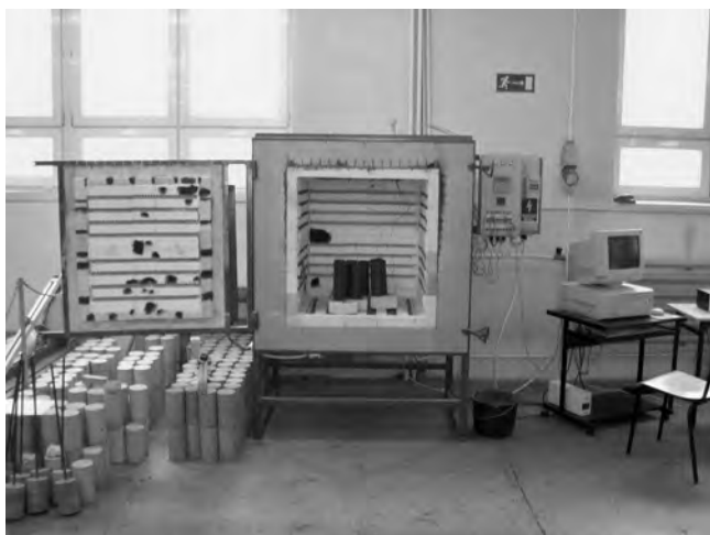
Fot. 1 Stanowisko badawcze – piec do wygrzewania próbek betonowych
