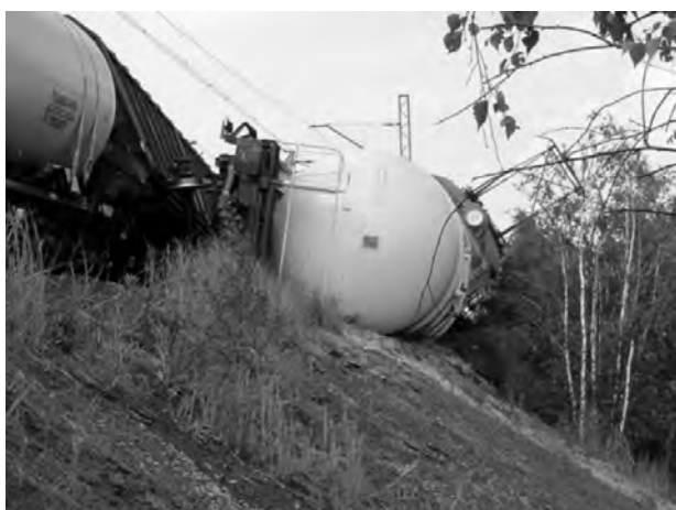
Fot. 2. Widok na wykolejoną cysternę z 1-oktanołem oraz na stojącą na torowisku cysternę z amoniakiem [1] Photo 2. View on the derailed tank with 1-octanol and standing on the trackway tank with ammonia [1]
