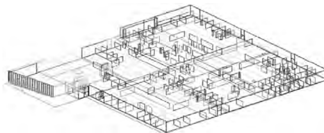
Ryc. 2. Widok geometrii antresoli w aplikacji typu CAD, tuż przed zaimportowaniem do programu FDS.
