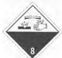
Ryc. 7. Oznakowanie cystern i autocystern - pomarańczowe tablice ostrzegawcze z numerami rozpoznawczymi 80/2031 oraz nalepka ostrzegawcza nr 8 wg RID/ADR.
