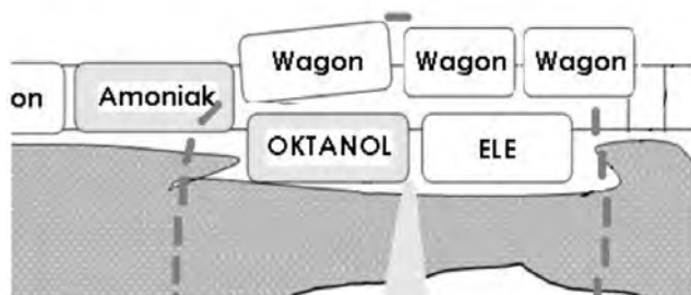
Ryc 2. Zasięg symulowanego oddziaływania strumienia ciepłego (czarna linia przerywana) o mocy 11,6 \text{ kW/m}^2 w przypadku zaistnienia pożaru rozlewiska 1-oktanolu we wstępnej fazie zdarzenia
