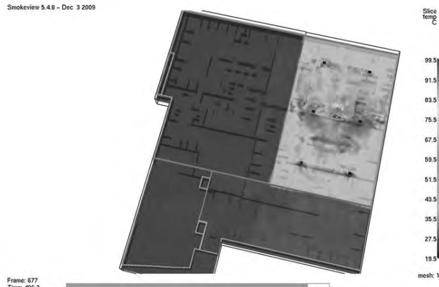
Ryc. 8. Rozkład temperatury dymu na wysokości warstwy dymu - 3,1 m, na poziomie antresoli. (Źródło: Opracowanie własne)
