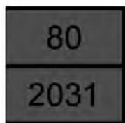
Ryc. 7. Oznakowanie cystern i autocystern - pomarańczowe tablice ostrzegawcze z numerami rozpoznawczymi 80/2031 oraz nalepka ostrzegawcza nr 8 wg RID/ADR.
