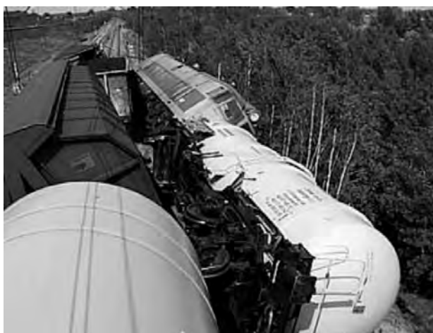
Fot. 1. Wykolejona część składu pociągu [1] Photo 1. Derailed part of the train [1]
