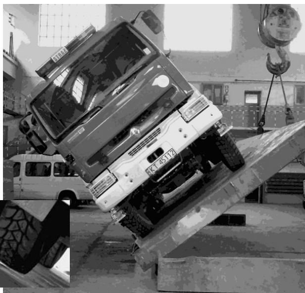
Fot. 1. Wyznaczanie kąta przechyłu bocznego na płycie uchylniej
