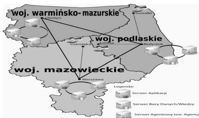
Ryc. 4. Przykładowa realizacja architektury agentowej dla warstwy programowej składającej się z trzech węzłów głównych Źródło: Opracowanie własne
