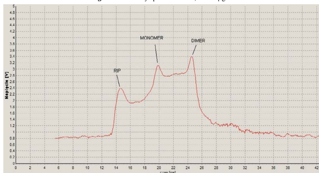
Ryc. 10. Spektrogram reakcji IMS na sarin, c = 380 \mu\text{g}/\text{m}^3
