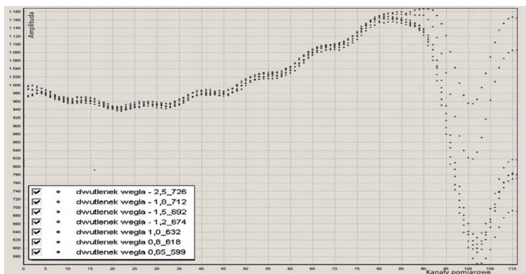
Ryc. 20. Spektrogram detekcji CO 2 dla różnych stężeń
