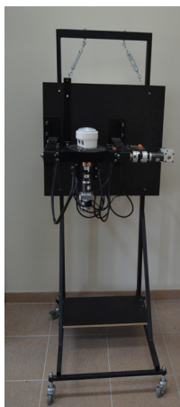
Ryc. 4. Stojak z zamocowaną próbką i elementem realizującym obrót
