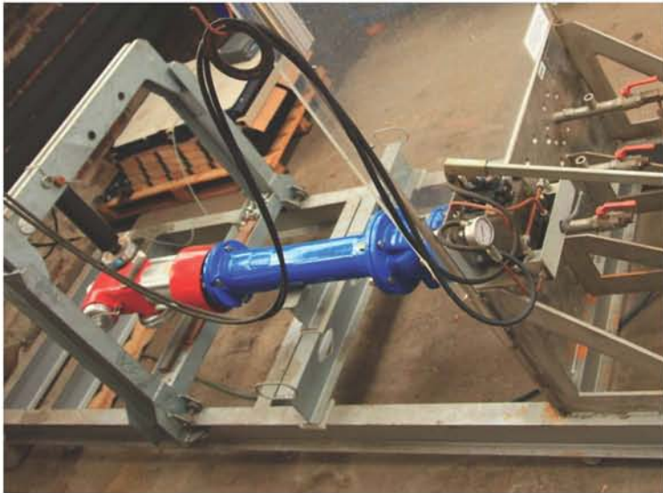
Fot. 18. Badanie odporności hydrantów na zginanie (Fotografia – S. Sowa)
