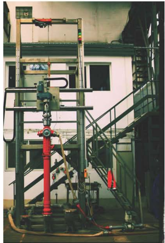
Fot. 19. Badanie trwałości hydrantów oraz siły działające powyżej poziomu gruntu (Fotografia – S. Sowa)
