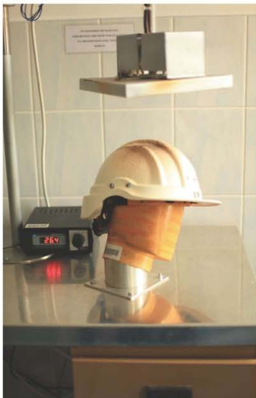
Fot. 16. Badania termiczne hełmu wg PN-EN 443 (Fotografia – S. Sowa)
