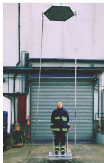
Fot 13. Badania przemakalności ubrań wg procedury badawczej CNBOP-PIB (Fotografia – S. Sowa)
