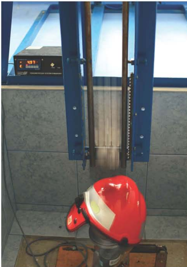
Fot. 14. i 15. Badanie zdolności amortyzacji przez hełm wg PN-EN 443 (Fotografia – S. Sowa)
