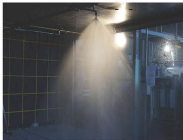
Fot. 1. Pomiary parametrów strumienia rozproszonego ze zraszacza (Fotografia – Archiwum CNBOP-PIB)
