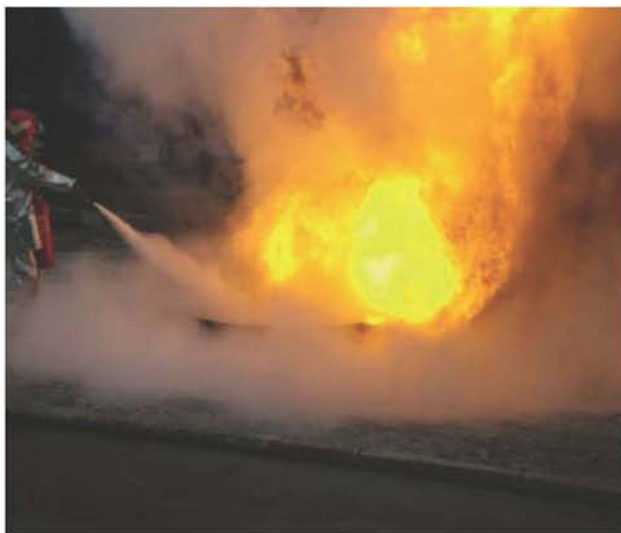
Ryc. 2. Badanie skuteczności gaśniczej w zakresie pożarów grupy „B”.
