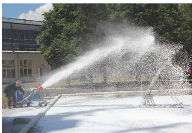
Fot. 4 i 5. Wyznaczanie parametrów piany z wytwornicy pianowej (Fotografia – P. Zbrożek)
