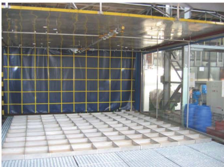
Fot. 9. Stanowisko do pomiarów intensywności zraszania tryskaczy i zraszaczy wg PN-EN 12259-1:2005 (Fotografia – archiwum CNBOP-PIB)
