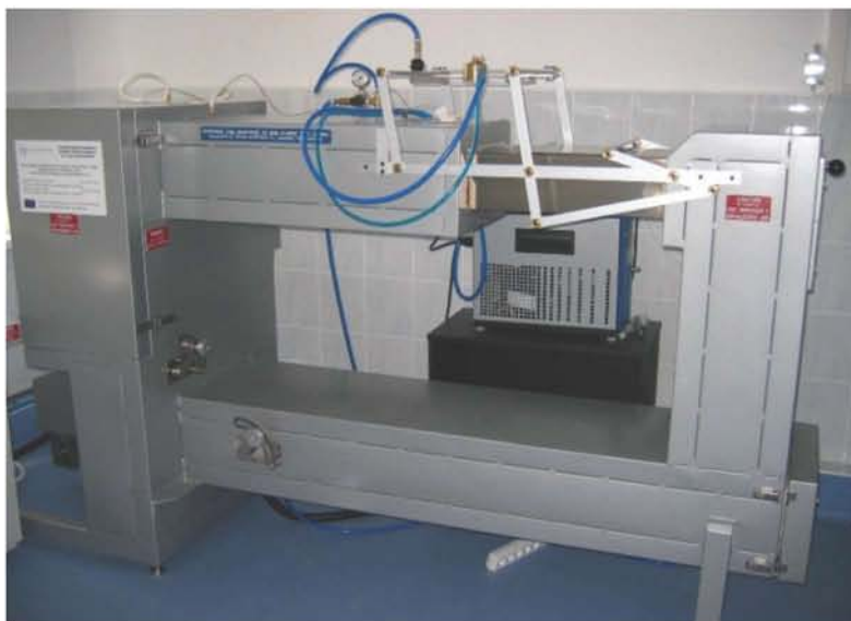
Fot. 11. Stanowisko do badań wskaźnika czasu zadziałania tryskaczy [RTI] oraz współczynnika przewodności [C] (Fotografia – archiwum CNBOP-PIB)
