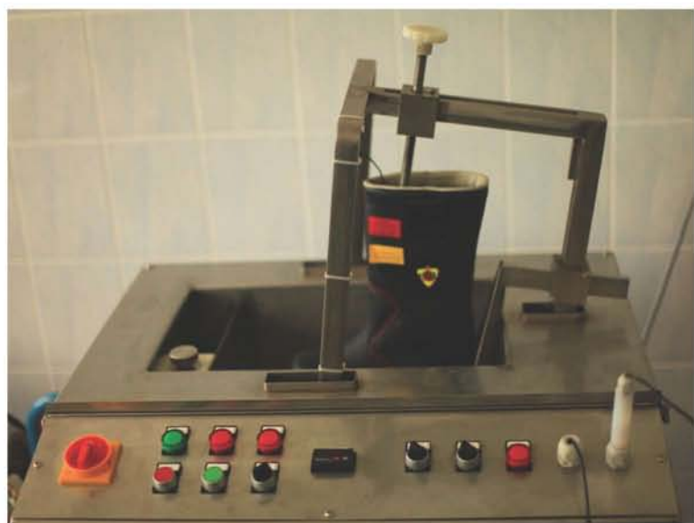
Fot 17. Badania odporności obuwia na przemkanie (Fotografia – S. Sowa)
