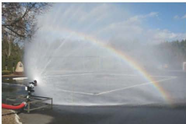
Fot. 2. Pomiary parametrów strumienia rozproszonego z działka wodnego (Fotografia – P. Zbrożek)
