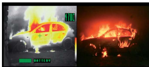
Rys. 5. Termogramu i fotografia samochodu w 27. minucie eksperymentu. Na termogramie krzyżem zaznaczone jest miejsce pomiaru temperatury.
