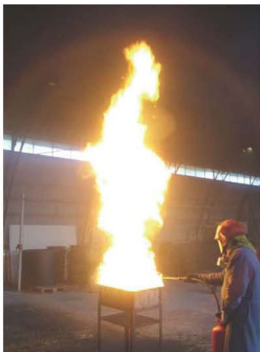
Ryc. 4. Badanie skuteczności gaśniczej w zakresie pożarów grupy „F”
