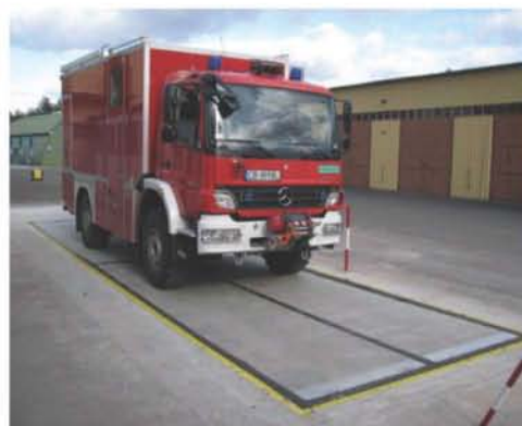
Fot. 7 i 8. Stanowisko do pomiaru statycznych obciążeń na osie i strony pojazdów pożarniczych (Fotografie – archiwum CNBOP-PIB)
