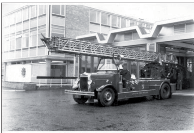
Ryc. 1. Drabina Metz z 1937 roku o wysokości 100 ft (30,5 m) [1].
