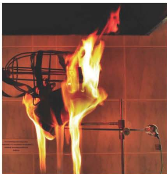
Fot. 12 Badania palności maski wg PN-EN 136 (Fotografia – S. Sowa)
