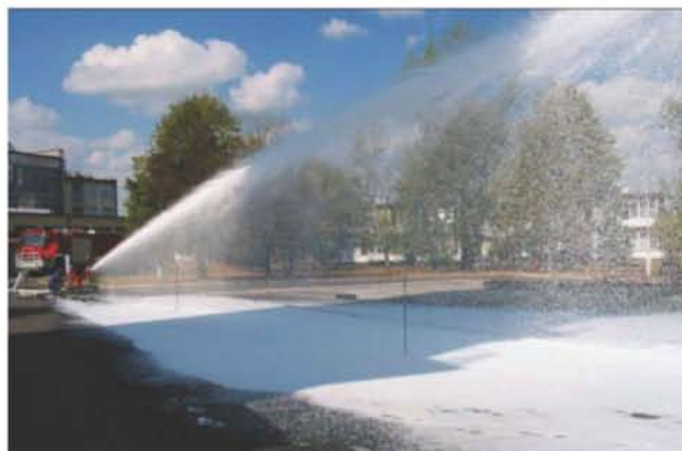
Fot. 3. Wyznaczanie zasięgu rzutu strumienia działka wodno-pianowego (Fotografia – Archiwum CNBOP-PIB)
