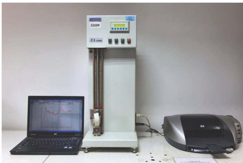
Fot. 20. Stanowisko do wyznaczania wytrzymałości adhezyjnej wężyz gumy i tworzyw sztucznych wg PN-EN 28033 (Fotografia – S. Sowa)
