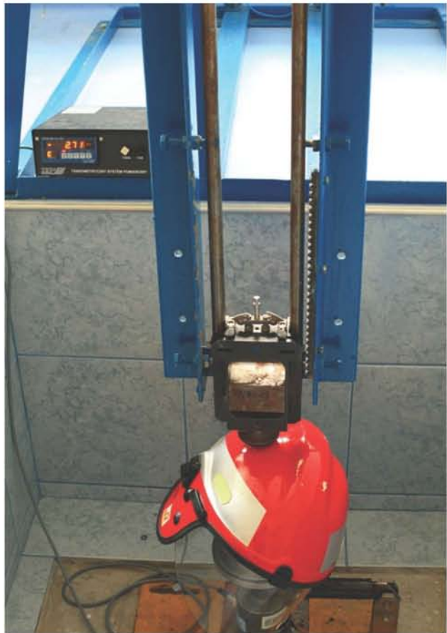
Fot. 14. i 15. Badanie zdolności amortyzacji przez hełm wg PN-EN 443 (Fotografia – S. Sowa)
