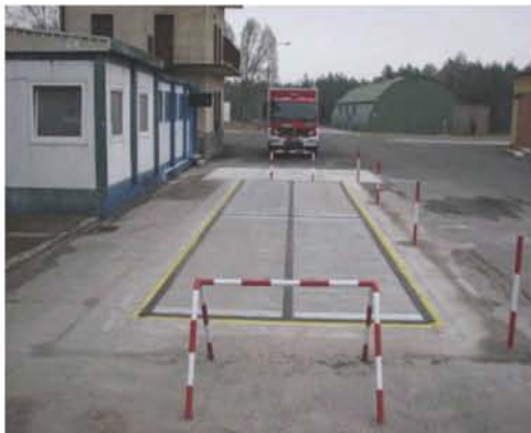
Fot. 7 i 8. Stanowisko do pomiaru statycznych obciążeń na osie i strony pojazdów pożarniczych (Fotografie – archiwum CNBOP-PIB)
