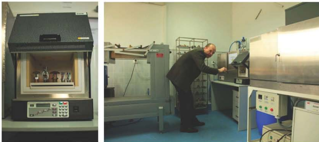
Fot. 10 Stanowisko do prób odporności cieplnej tryskaczy wg PN-EN 12259-1 (Fotografia – S. Sowa)
