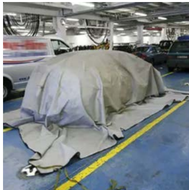
Figure 14. View of an electric vehicle secured with a fire cloth Rycina 14. Widok pojazdu elektrycznego zabezpieczonego płachtą gaśniczą
