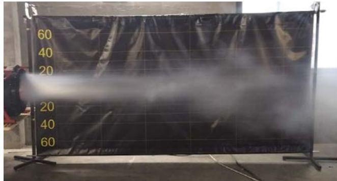
Figure 6. Visualization of the shape of the air stream generated by a “turbo” fan – experimental research Rycina 6. Wizualizacja kształtu strugi powietrza wygenerowanej przez wentylator typu „turbo” – badania eksperymentalne Source: Own elaboration. Źródło: Opracowanie własne.
