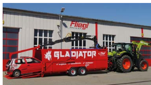
Figure 12. A specialized trailer for transporting and extinguishing electric vehicles Rycina 12. Specjalistyczna przyczepka do transportu i dogaszania pojazdów elektrycznych
