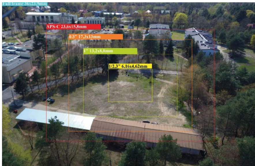
Figure 5. Image size depending on the size of the matrix in relation to the full frame matrix Rycina 5. Wielkość zdjęcia w zależności od rozmiaru matrycy w odniesieniu do matrycy pełnoklatkowej (ang. full frame )
