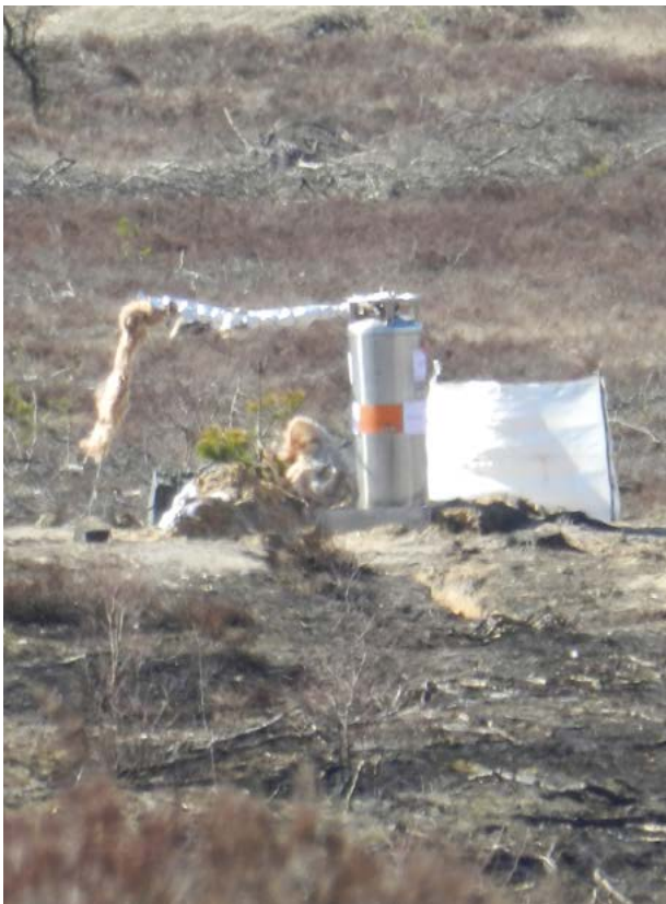
Figure 2. LNG tank placed in a tank with gasoline and diesel fuel Rycina 2. Zbiornik z LNG ustawiony w wannie z benzyną i olejem napędowym
