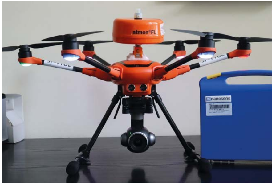
Figure 17. Yuneec Typhoon H520 with installed ATMON FL air quality measurement system by Nanosens Rycina 17. Yuneec Typhoon H520 z zamontowanym systemem pomiaru jakości powietrza ATMON FL firmy Nanosens Source: Own elaboration. Źródło: Opracowanie własne.
