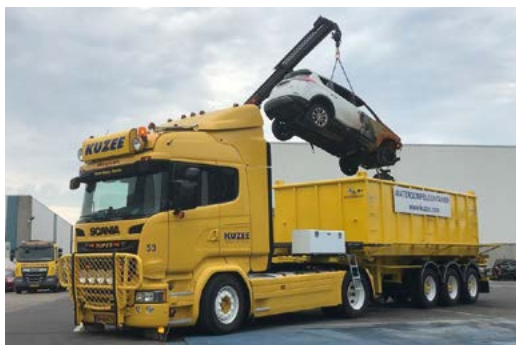
Figure 11. Container for transporting electric car wrecks Rycina 11. Kontener do transportowania wraków samochodów elektrycznych
