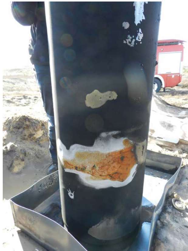
Figure 3. LNG tank after activation of the safety valve and after burning Rycina 3. Zbiornik LNG po aktywacji zaworu bezpieczeństwa i spaleniu
