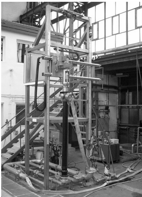
Fot. 3. Badanie trwałości hydrantu nadziemnego
