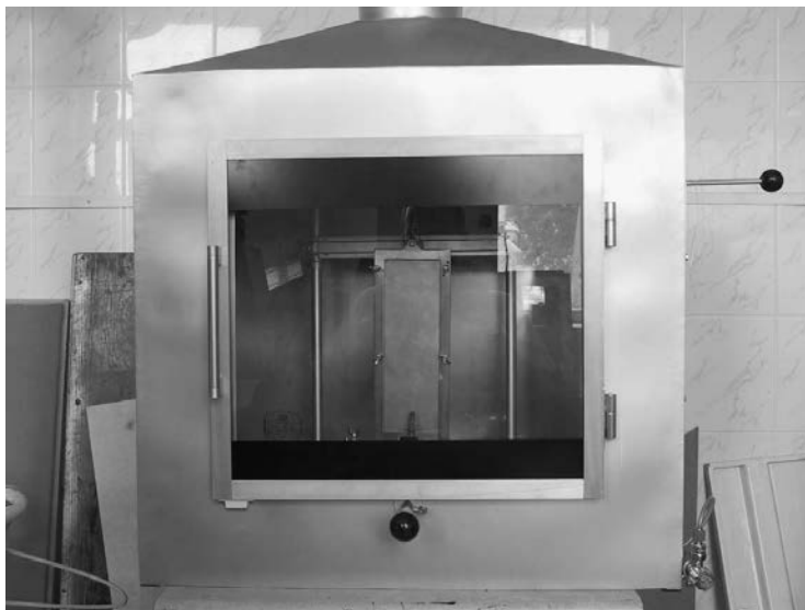
Ryc.2. Stanowisko do badania zapalności materiałów poddawanych bezpośredniemu działaniu pojedynczego płomienia
