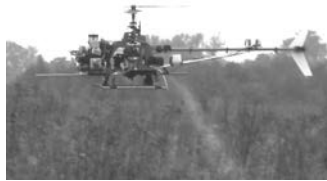
Fot. 2. Wytwarzanie dymu wizualizujące kierunek śladu wirnika
