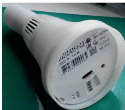
Рисунок 2. Общий вид опытного образца комбинированного пожарного извещателя
