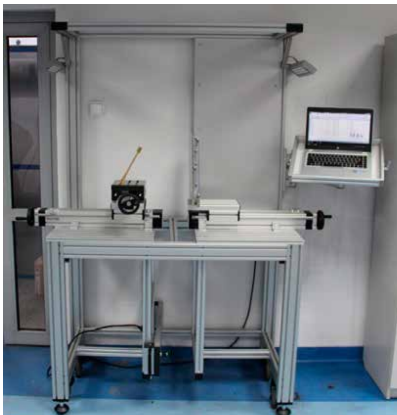
Ryc. 5. Widok stanowiska badawczego – oddziaływanie płomienia (etap testów i modyfikacji) [21]
