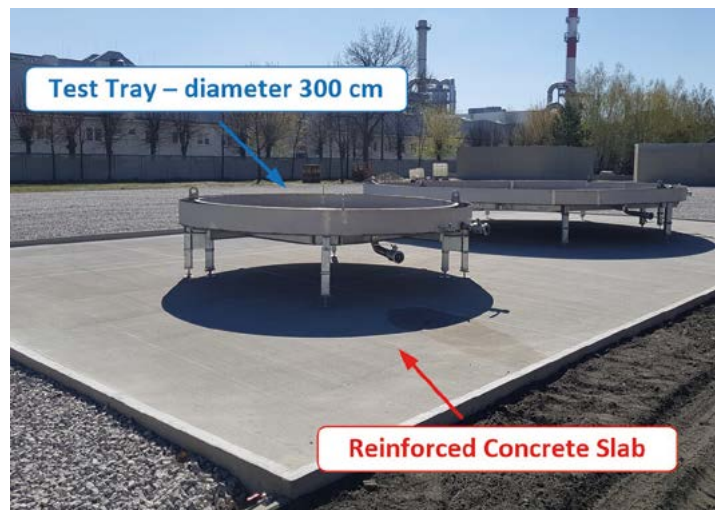
Figure 1. Pool fire test stand Rycina 1. Stanowisko do badania pożarów powierzchniowych Source: Own elaboration. Źródło: Opracowanie własne.
